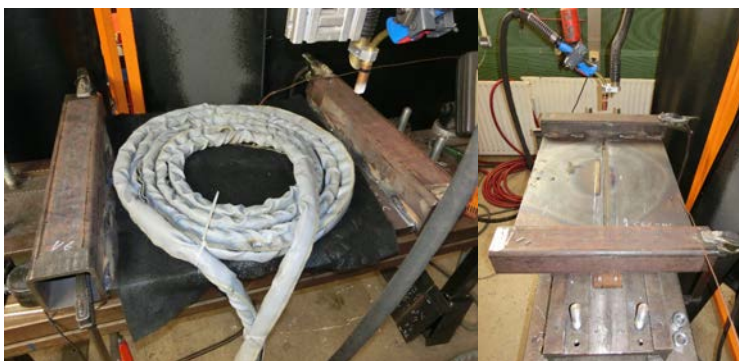
Bild 1. Induktive Vorwärmung und Fertigung einer Schweißprobe (Blechdicke t = 20 \text{ mm} ; V-Naht)
