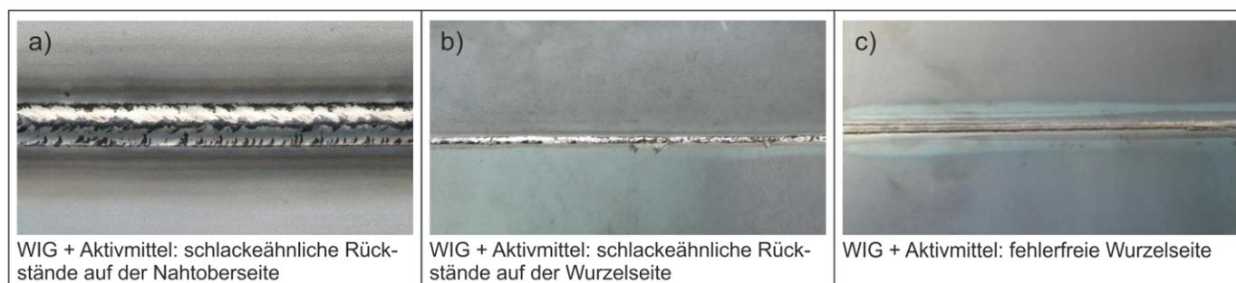
**Bild 3.** Bildung von schlackeähnlichen Substanzen im Nahtbereich beim WIG-Schweißen mit einem TiO<sub>2</sub>-Kaliwasserglas-Gemisch.
