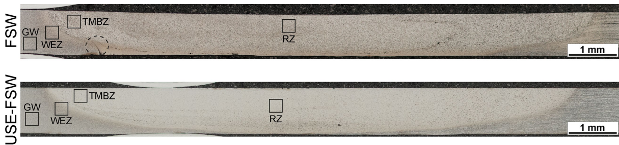
Bild 4: Vergleich der Mikrostruktur zwischen FSW- und USE-FSW-Versuchen durch lichtmikroskopische Querschliffaufnahmen bei fünffacher Vergrößerung
