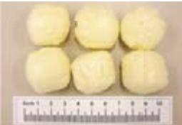
Bild 1: Die Formierbällchen sind derzeit in drei Größen lieferbar: 30 bis 32 mm, 43 bis 45 mm und 52 bis 55 mm.
