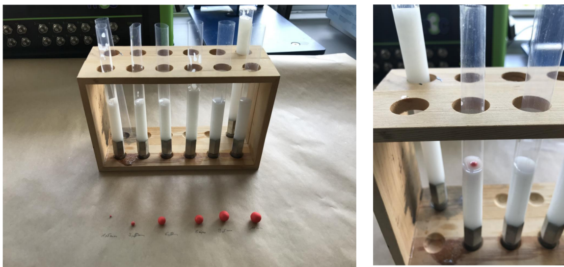
Bild 5. Experimentelle Abbildung einer Luftblase mittels Styroporkugeln unterschiedlicher Durchmesser (1,5 - 10 mm)
