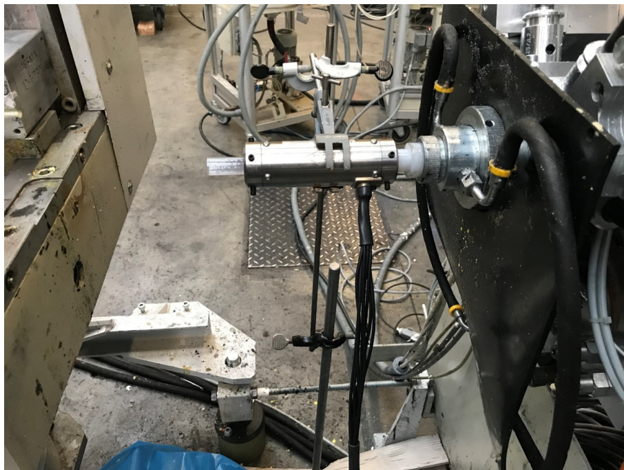
Bild 7. Musterdosieranlage mit montiertem ECT-Sensor
