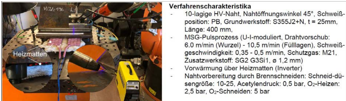
Bild 3. Versuchsaufbau zum MSG-Mehrlagenschweißen sowie konduktiver Probenvorwärmung
